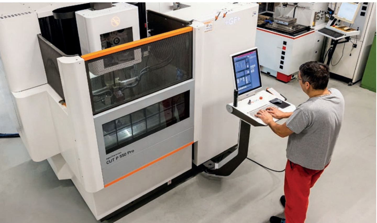
Die neue Drahterodiermaschine zur hochpräzisen Produktion von metallischen Werkzeugen und komplexen Formen.
