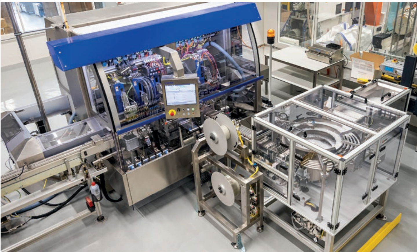
Der neue Ventilmontageautomat der Wipf AG. Kapazitätserweiterung zur Herstellung der WICOVALVE®- Einwegaromaschutz-Ventile.
