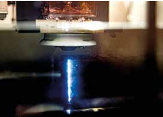
**Der Maschinenpark der Michel Werkzeugbau AG wurde um ein neues Mitglied erweitert: Die neue Drahterodiermaschine der GF Machining Solutions Sales Switzerland SA ist eine hochpräzise Werkzeugmaschine für die industrielle Fertigung. Durch den Einsatz eines dünnen Drahtes und Strom können elektrisch leitende Materialien sehr präzise bearbeitet werden.**
